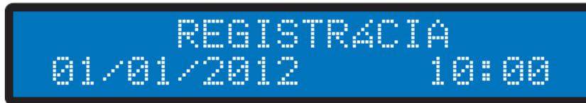
Zařízení je vybaveno dvouřádkovým 20 místným alfanumerickým LCD displejem umístěným nad klávesnicí. Orientace a zadní podsvícení jej činí viditelným i pro prodavače, i pro zákazníka. Kontrast displeje můžete měnit v systémových nastaveních pokladny.
